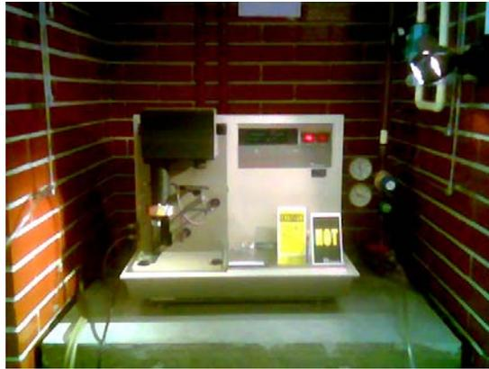
Figura 20. Analizador Termogravimétrico, T.A. Instruments Mod. 2950. IIM.UNAM
