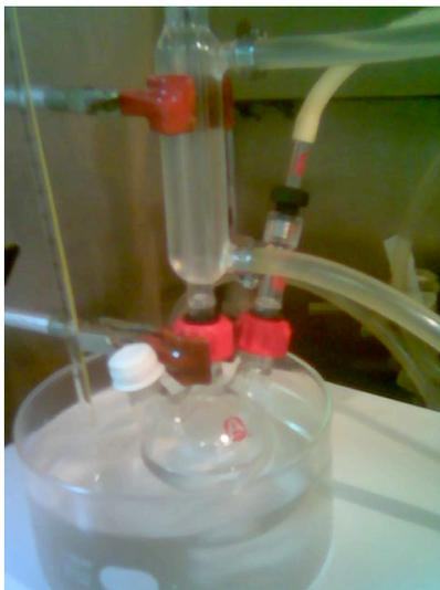
Figura 35. Sistema de reacción para el proceso de sililación del BIS-GMA. Temperatura del baño de  $80\text{ }^{\circ}\text{C} \pm 2\text{ }^{\circ}\text{C}$ , flujo continuo de nitrógeno gaseoso y reflujo con circulación continua de agua a  $12\text{ }^{\circ}\text{C} \pm 1\text{ }^{\circ}\text{C}$ .
