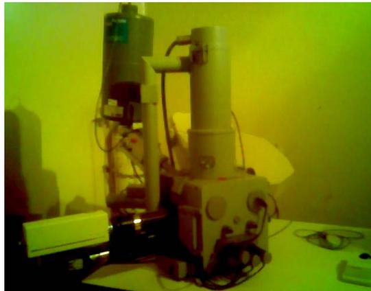
Figura 32. Microscopio Electrónico de Barrido Cambridge Leica
