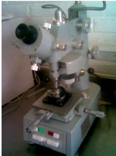
Figura 31. Durómetro Shimadzu. Modelo 4464. IIM. UNAM.
