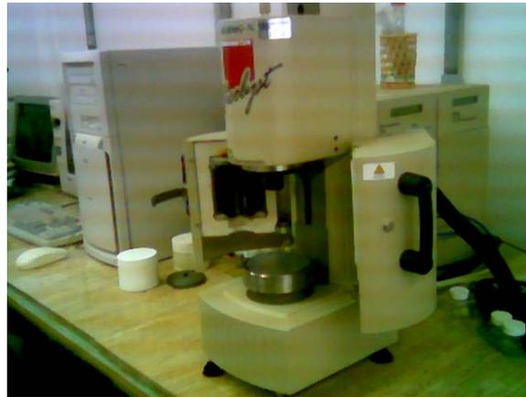
Figura 29. Reómetro TA Instruments AR1000-N. IIM. UNAM.
