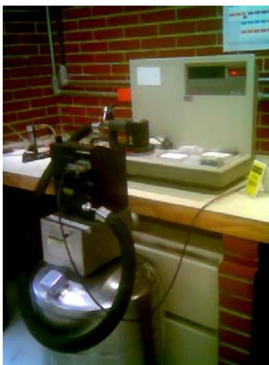
Figura 19. Calorímetro Diferencial de Barrido T.A. Instruments Mod. 2910. IIM.UNAM
