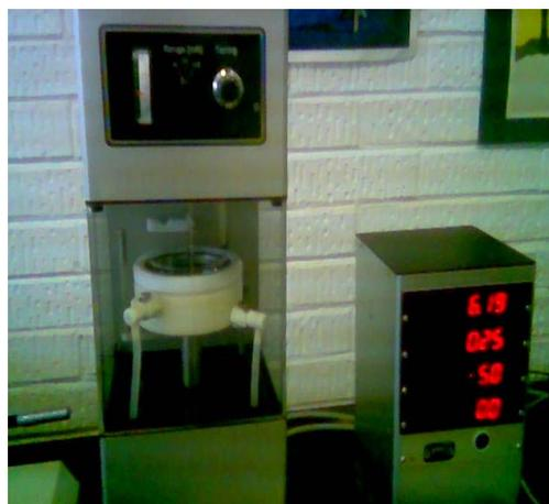
Figura 25. Balanza de Wilhelmy KSV Sigma 70, IIM.UNAM.
