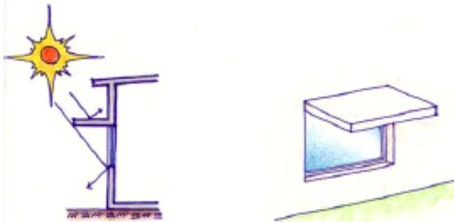
**Vanos remetidos;** esta propuesta, tiene la ventaja de manejar aleros y parasoles en una misma solución, ya que protegen de la radiación solar en cualquier dirección.
