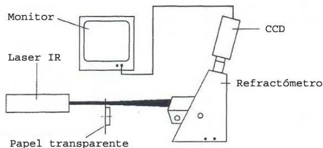
Fig. 2.3 Medición del índice de refracción en el espectro cercano al IR usando un refractómetro tipo Abbe [2]
