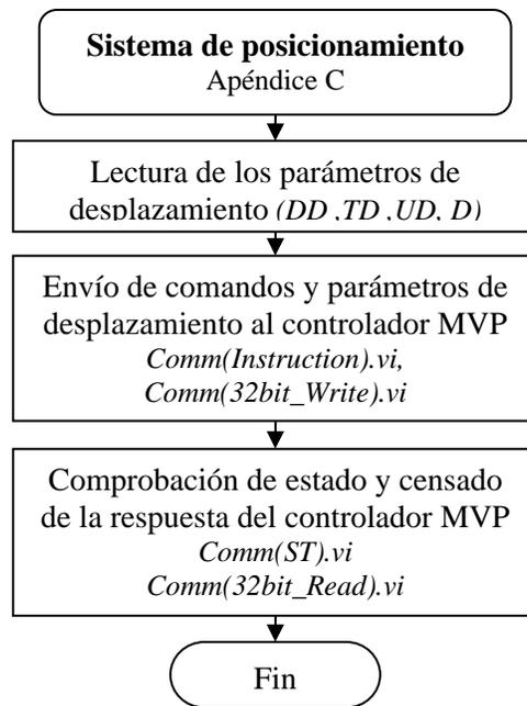
Fig. 4.4 Diagrama de bloques del sistema de posicionamiento
