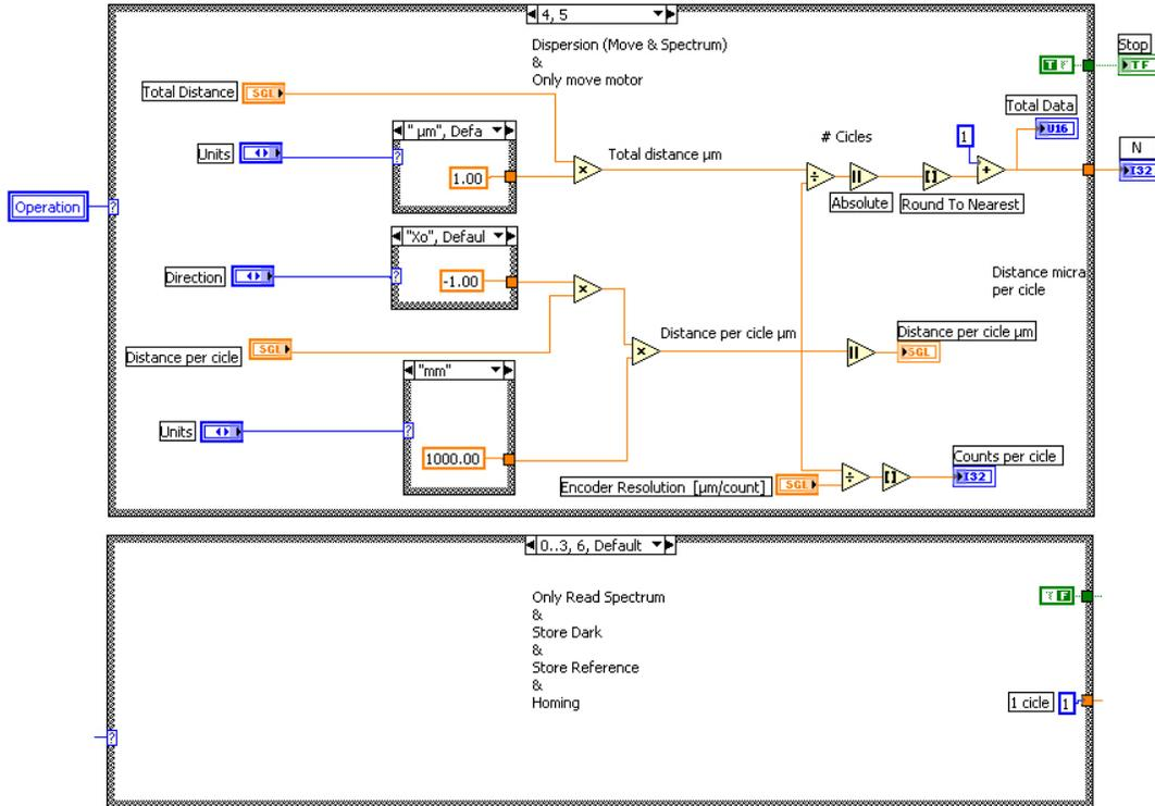
Figura E.4 Cálculo de parámetros de desplazamiento de la platina micrométrica lineal
