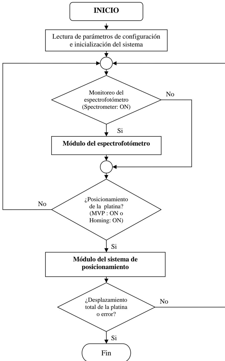
Fig. 4.2 Diagrama de bloques del módulo principal
