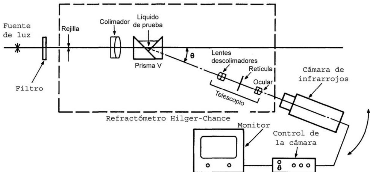
Fig. 2.4 Medición del índice de refracción en líquidos [3]
