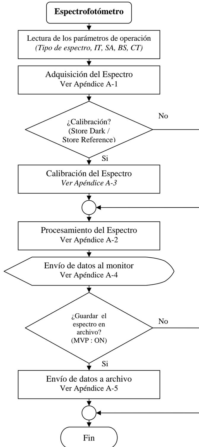
Fig. 4.3 Diagrama de bloques del módulo de control del espectrofotómetro
