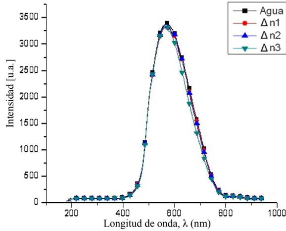
**Fig. 5.4 Espectro de transmisión para agua tridestilada y para diferentes concentraciones de sucrosa medido sobre un mismo punto sobre el eje de la platina**
