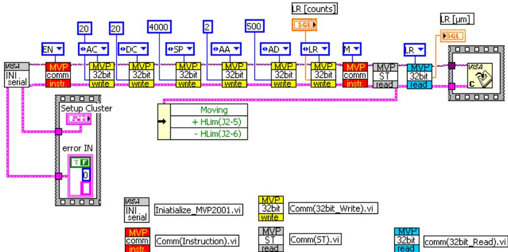
Fig. C.1 Diagrama de código del controlador MVP 2001
