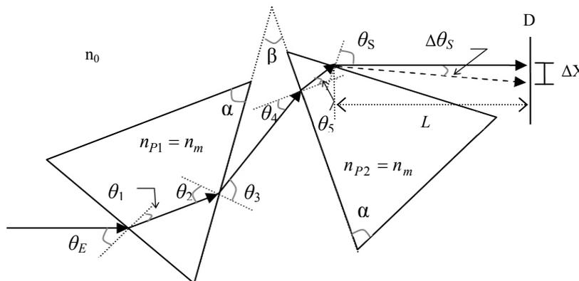
Fig. 3.1 Refractómetro de doble prisma.
