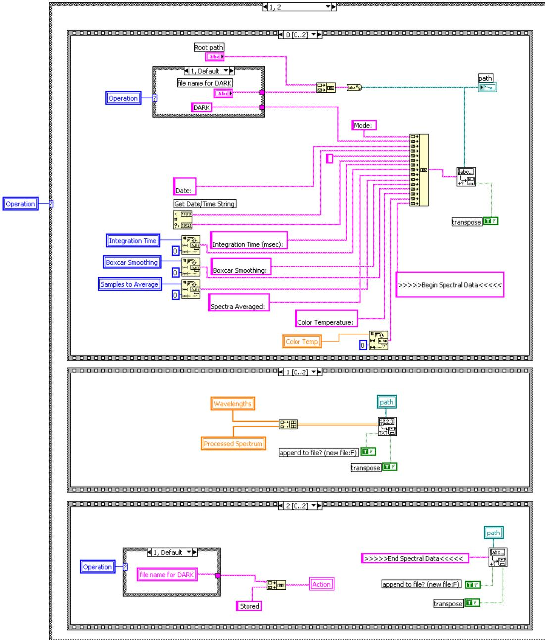
Figura E.9-a Almacenamiento en archivo del espectro de calibración seleccionado
