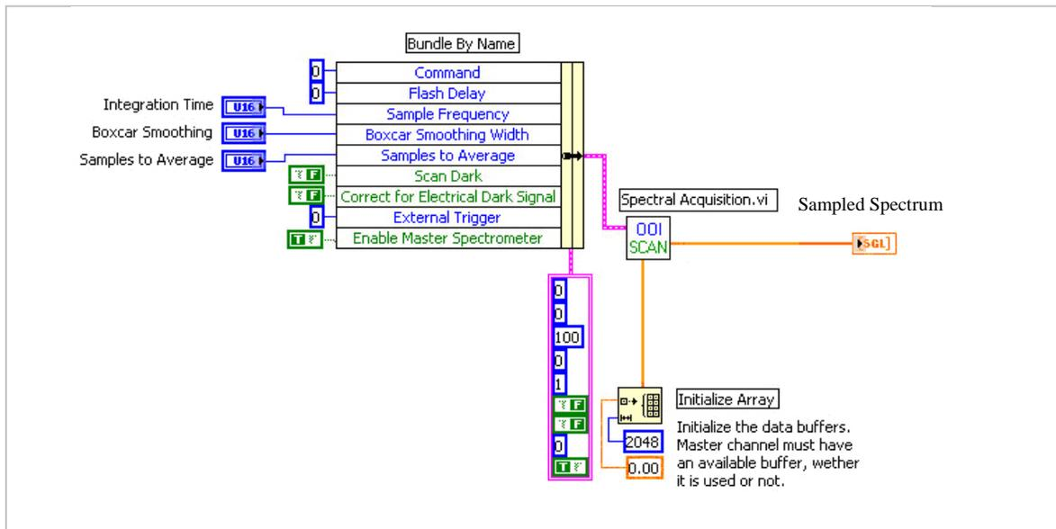
Fig. A.1 Adquisición de la señal espectral
