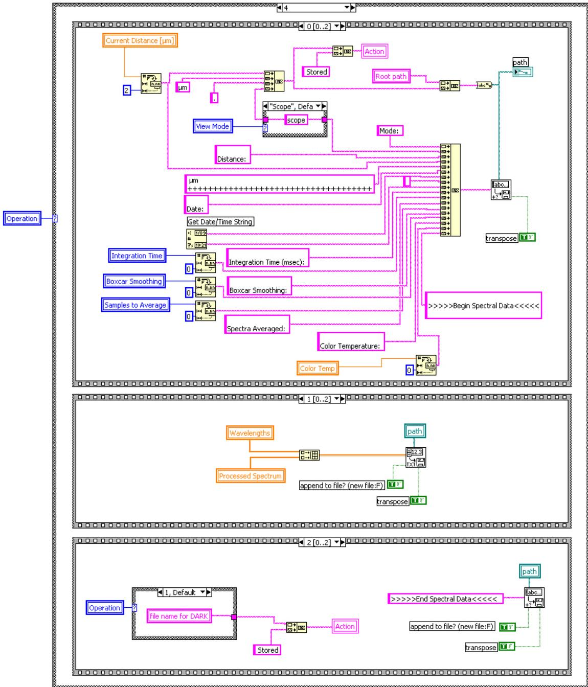
Figura E.9-b Almacenamiento del espectro y de la posición de la platina en archivo
