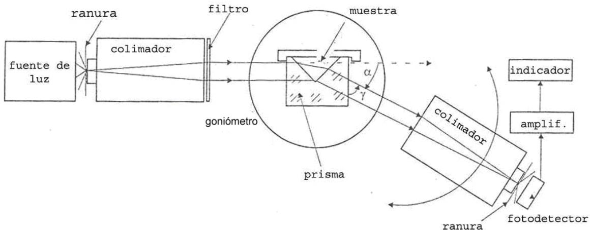
Fig. 2.5 Medición del índice de refracción de plásticos ópticos [4]
