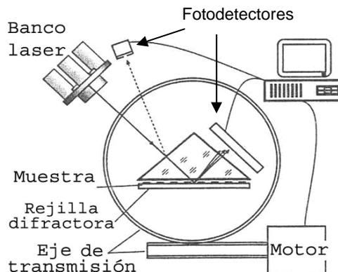
Fig. 2.2 Refractómetro automático de frecuencias cercanas al infrarrojo [1]
