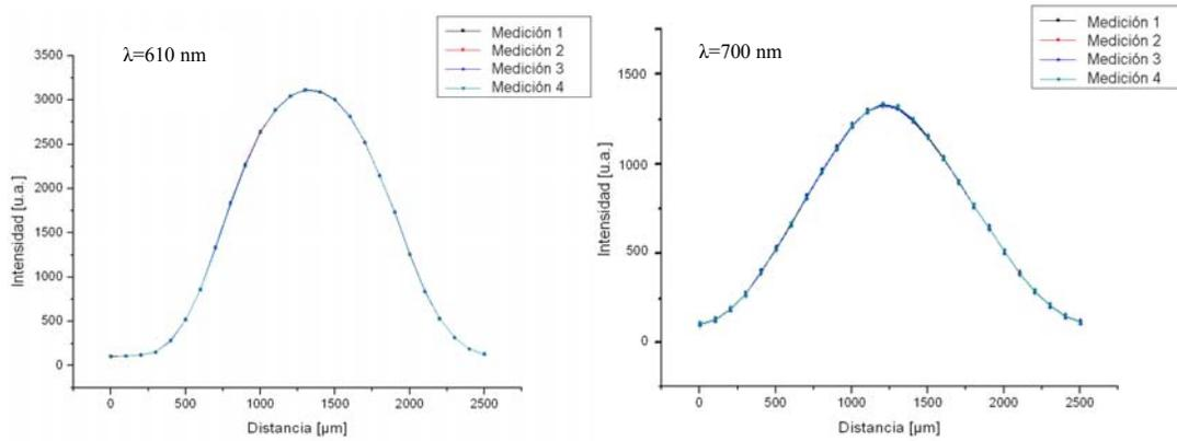
**Fig. 5.2 Perfiles de onda para  $\lambda=610$  nm y  $\lambda=700$  nm obtenidos para una misma muestra de agua tridestilada**
