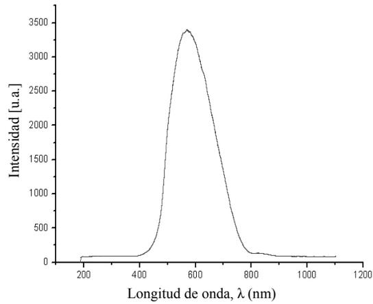
**Fig. 5.1 Espectro de transmisión para agua tridestilada medido sobre un punto arbitrario sobre el eje de la platina**
