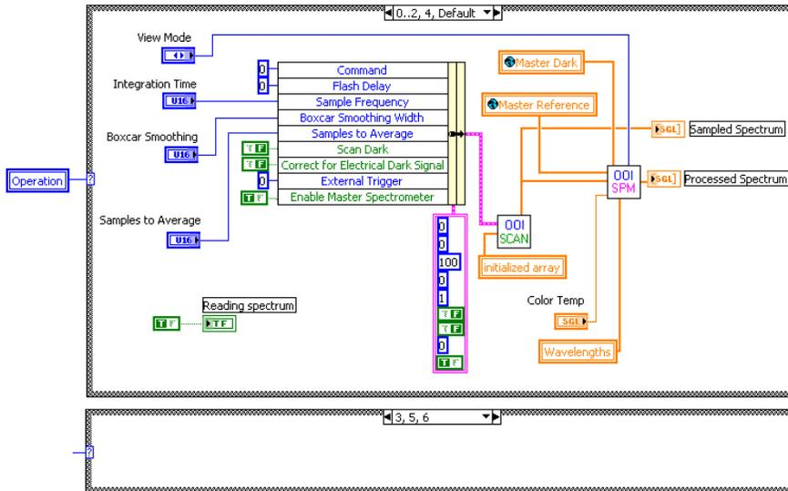
Figura E.6 Censado de la señal óptica y procesamiento de la señal con base en el modo espectral seleccionado
