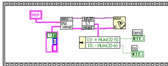
Figura E.5 Censado de la posición de la platina
