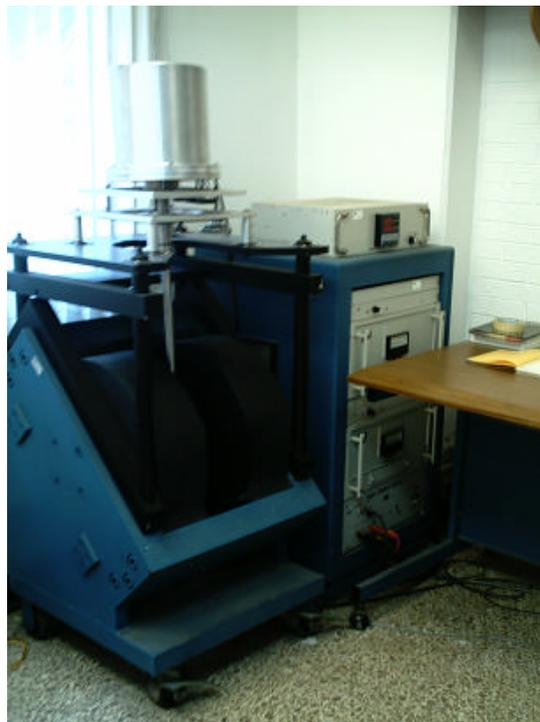
Fig. 3.5 Magnetómetro de muestra vibrante Marca LDJ 9600.
