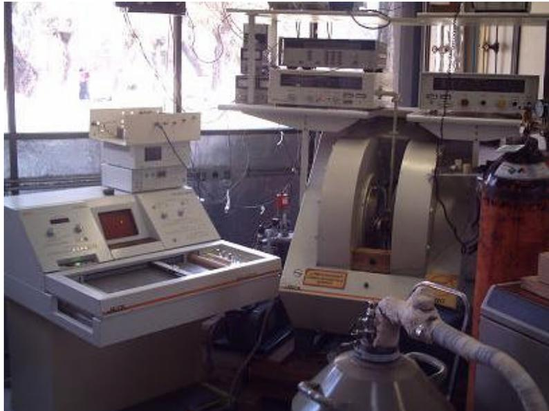
Fig. 2.1 Espectrometro EPR (resonancia paramagnética electrónica) JEOL modelo JES-RF3X-
