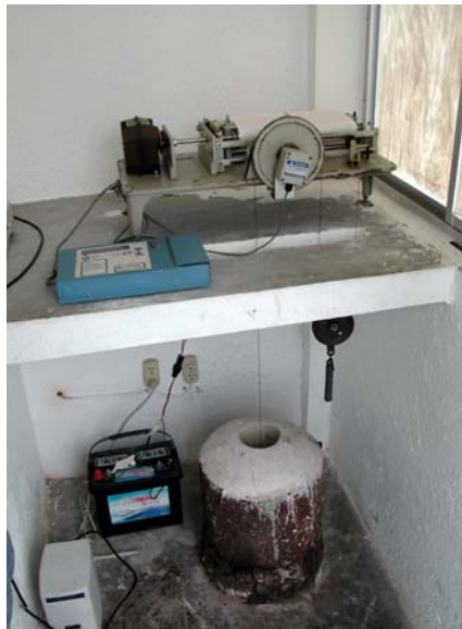
Fig. 1.3. Mareógrafo instalado en la estación Club de Yates de Acapulco (ACYA).
