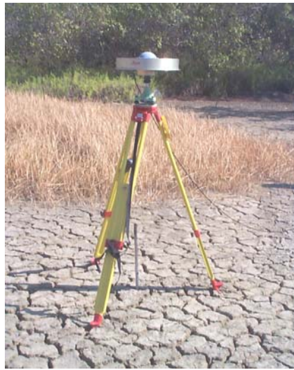
Fig. 3.1. Sedimentación reciente con un grosor de 3 a 5 cm., periodo seco. La antena AT504 instalada sobre el punto de la perforación.
