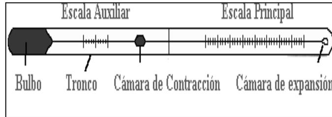
**Figura 4.- Partes del termómetro de mercurio**
