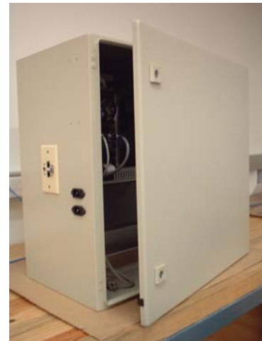
Fig. 4.9 Gabinete que almacena las computadoras Octagon y fuente de alimentación.
