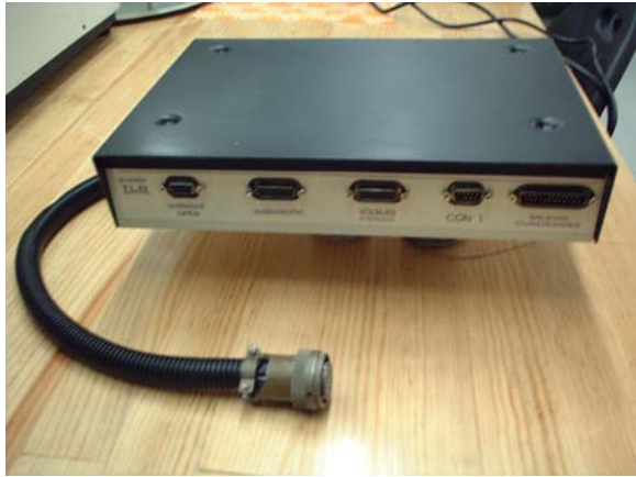
Fig. 4.8 Mochila-gabinete que almacena la tarjeta de preamplificación y conversión A/D.
