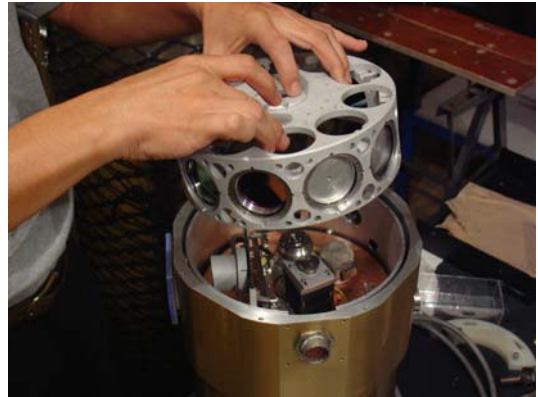
Colocación del carousel.
