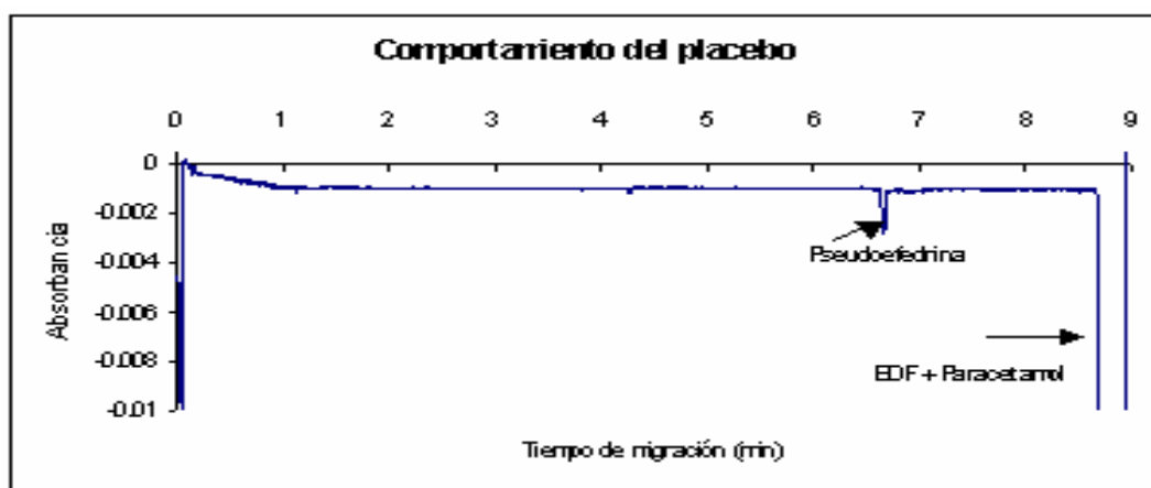
Fig. 15 Electroferograma del comportamiento del placebo plus. Condiciones: 50 mM buffer de 4-metilbencilamina, pH 10.0, 30 kV, 25 °C, inyección hidrodinámica 0.5 psi, 10 s. Capilar de Sílice fundida 75 \mu m de diámetro interno, 125 cm de longitud total (46 cm de long. al detector), detección a 216 nm.
