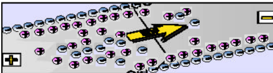
Fig G2. Separación de las moléculas por el flujo electro osmótico con base en su carga y masa.
