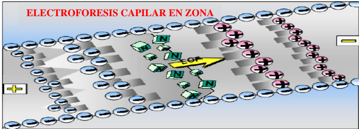
Fig G7. Mecanismo de la separación en la electroforesis capilar de zona.
