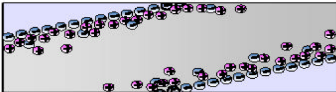
Fig G5. Representación de la introducción del buffer al capilar, se observa también la adsorción de cationes a los grupos silanol ionizados ubicados en la pared del capilar.
