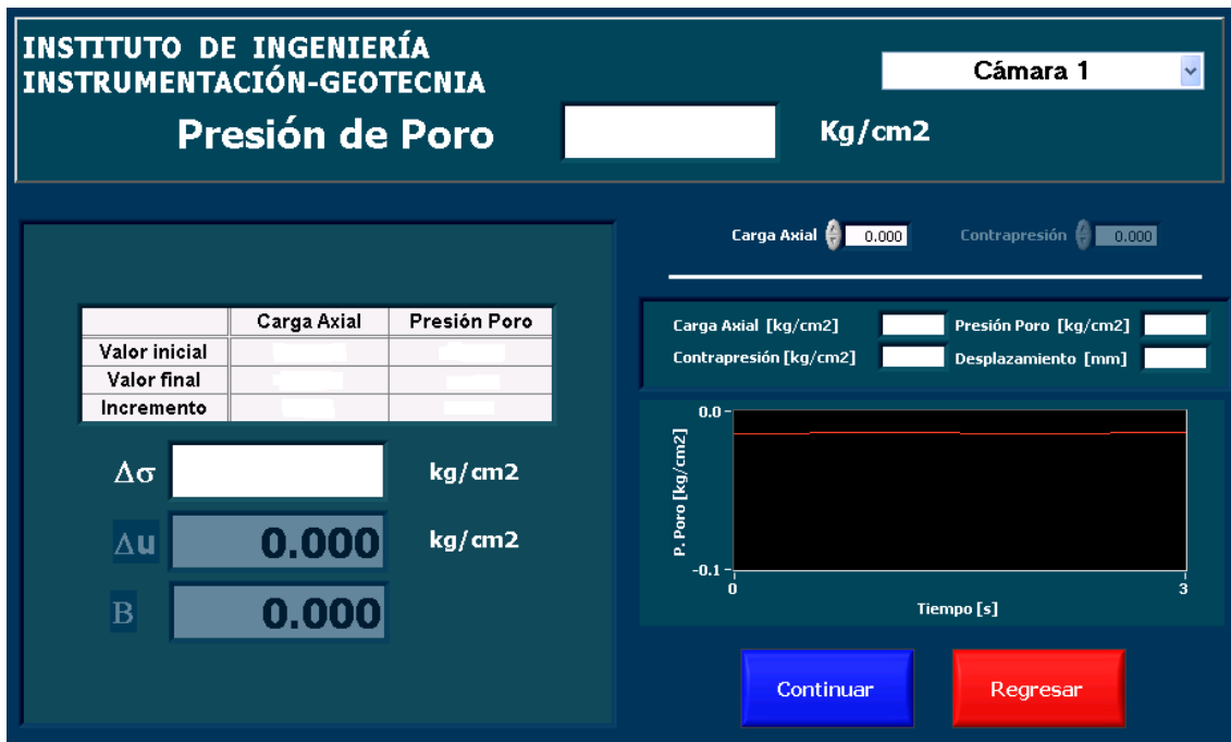
Figura 60. Panel frontal con la gráfica de la presión de poro vs. tiempo.
