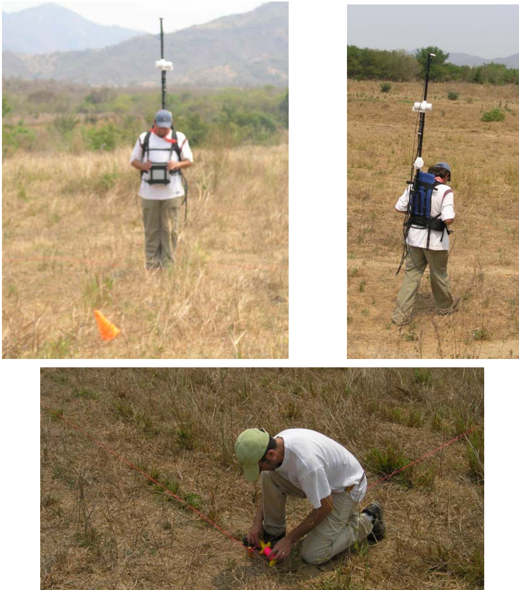
Figura 5.1.2. Levantamiento magnetométrico y delimitación del microlevantamiento
