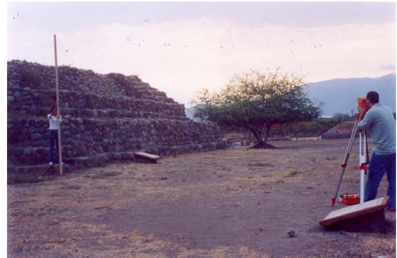
Foto 3.5 Medición de la Estructura 5, de La Campana, utilizando teodolito y estadal, hecha desde el juego de pelota. (Foto archivo personal)
