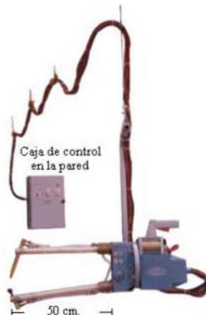
Figura 9.2. A la izquierda puerta colocada en un herramental para ser soldada, a la derecha, pistola tipo "C" de brazos largos.
