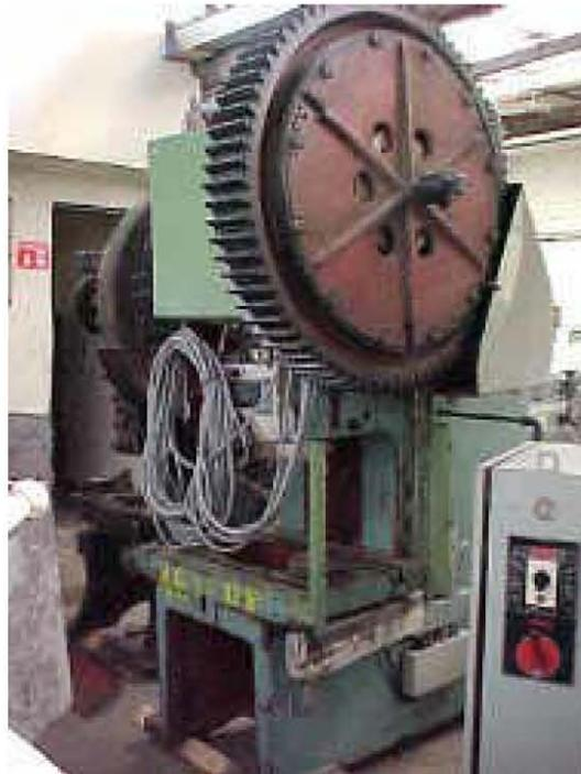
Figura 9.4. Maquina forjadora durante la operación sin implementación.
