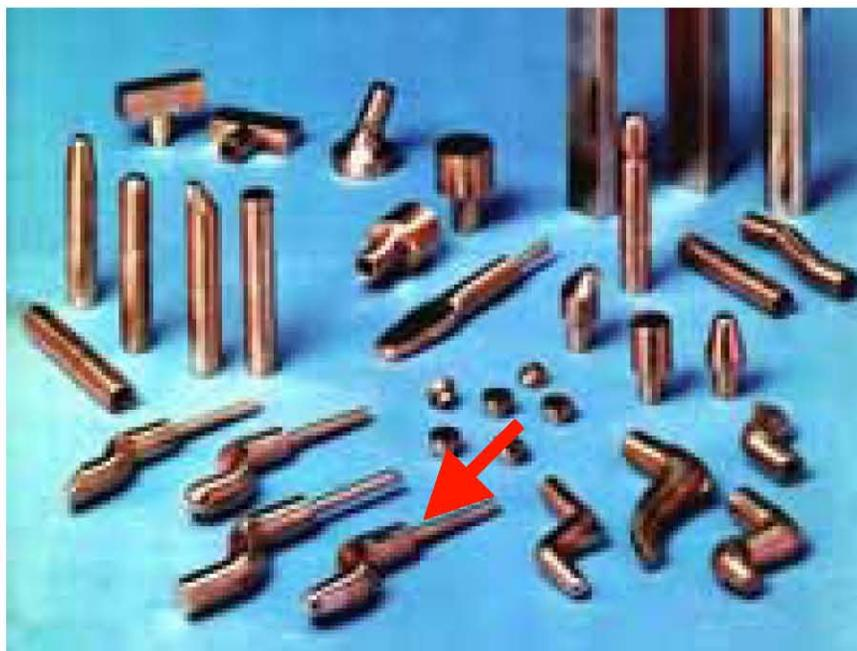
Figura 9.3. Familia de electrodos en donde se aprecia el Z25
