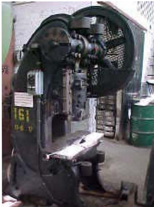
Figura 5.5. Máquina en espera de cambio de troquel (tiempo muerto).
