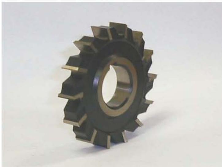
**Figura 2.1 Fresa para corte lateral**
