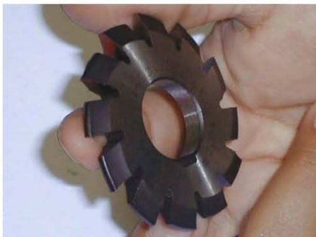
**Figura 2.2 Fresa cortadora de engranes**
