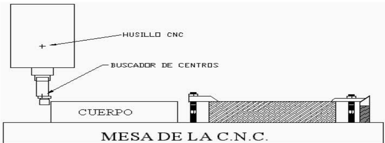
Figura 3.14. Tomando las coordenadas con buscador de centros.
