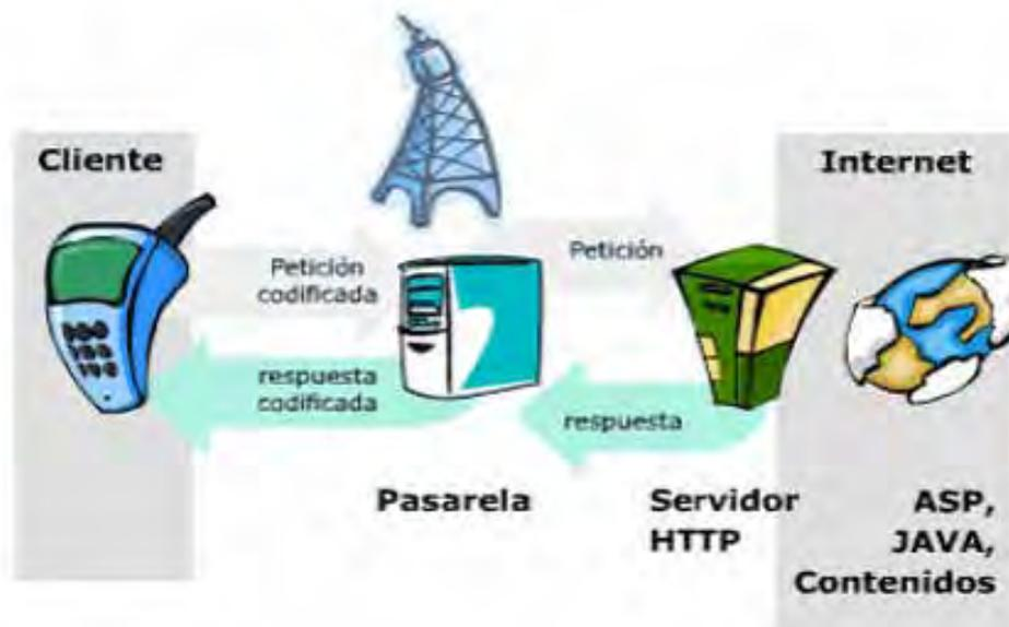
Fig. 2.2 Modelo de funcionamiento del WAP.
