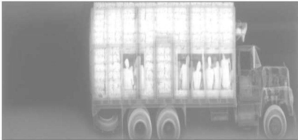
Imagen No. 3. Aquí se muestra la forma en que se detectaban dobles fondos por medio del sistema Mobilesearch. (www.as&e.com)
