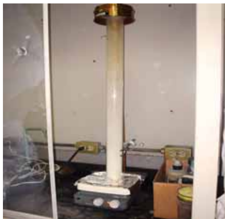
Fig. 3.1 Dispositivo en el que se llevo a cabo la síntesis por combustión, en la parte superior se coloca un tamiz para evitar perdidas del producto.
