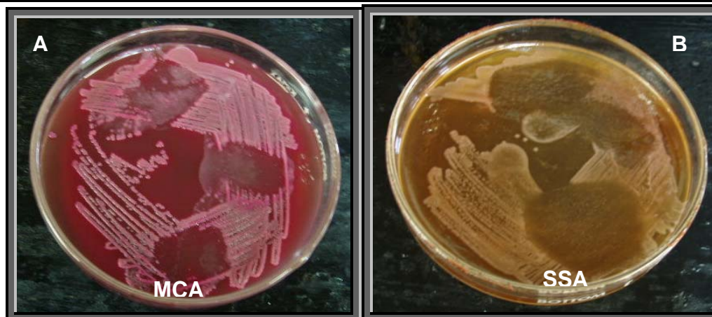
Figura 14.- Prueba de inhibición del recubrimiento con antimicrobiano al 0.02%, frente a E. coli H10407 (A) y S. typhi (B)
