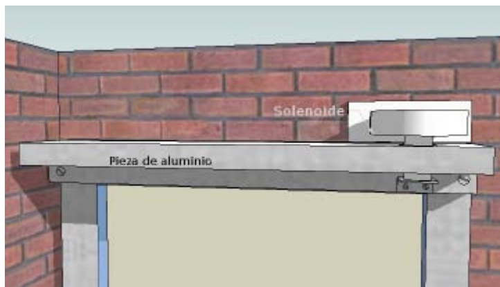
Fig. 2.16 Solenoide atrancando la parte superior de la puerta corrediza
