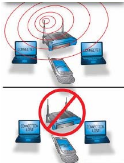
Fig. 1.12 Un Access Point (en el centro), permite a varios dispositivos conectarse a Internet al mismo tiempo. [14]
