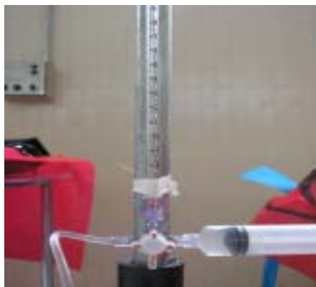
Foto 5.- PVC fijo a la altura de la espina iliaca anterosuperior del perro donde se mide la presión intravesical
