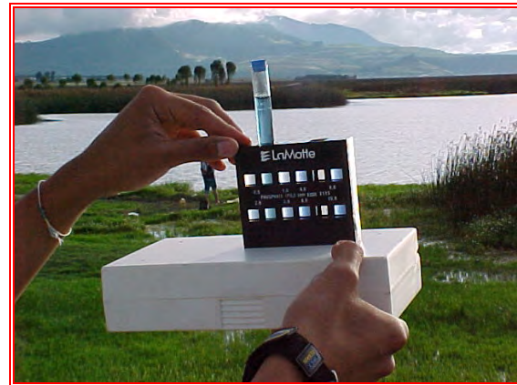
Fotografía 18. Lectura de calidad del agua de los humedales.
