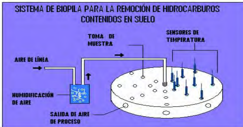
Figura 2.2. Esquema de alimentación de aire, puntos de muestreo y medición de temperatura.
