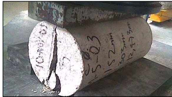
Fig. 3.17 Falla de cilindro ensayada a tensión indirecta.
