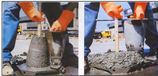
Fig. 1.14 Prueba de Revenimiento
