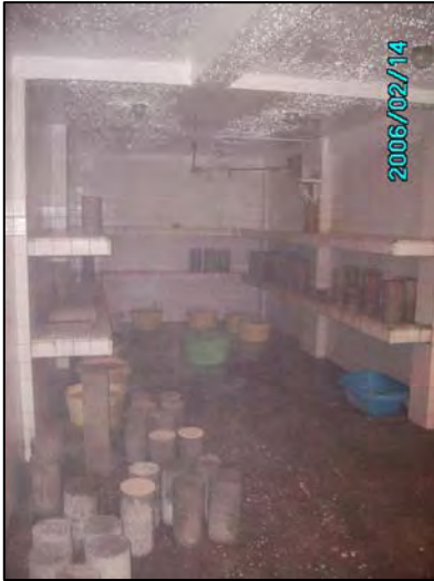
Fig. 2.3 Cámara Húmeda. H. R. de 100%
