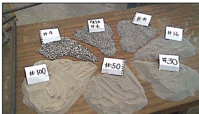
Fig. 3.6 Varios tamaños de partículas que se encuentran en el agregado fino.
