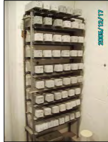
Fig. 3.20 Barras de CBR de 7.5 X 7.5 x 28 cm en cámara seca
