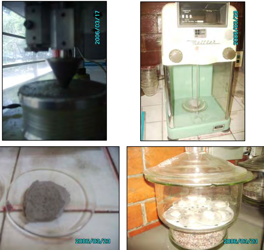
Fig. A6.5 Cono penetrando en molde (superior izquierda), Balanza con capacidad de 160 gr (superior derecha), Arena mal graduada con limo (inferior izquierda) y desecador de material (inferior derecha)
