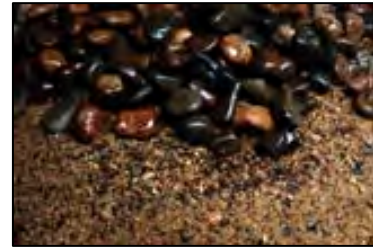
Fig. 1.6 Agregado fino y grueso
