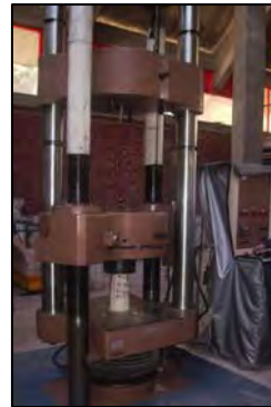
Fig. 3.13 Máquina universal de capacidad de 250 ton. (Izquierda)
