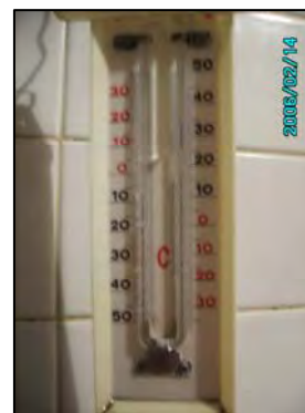
Fig. 2.2 Termómetro en cámara húmeda. Temperatura prom. 23 °C.
