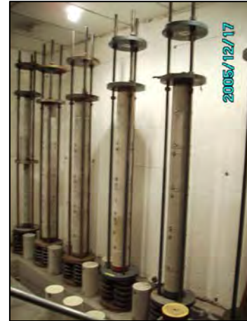
Fig. 3.25 Marcos para flujo plástico en la cámara seca
