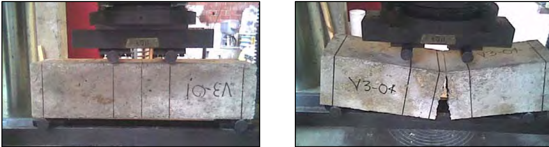
Fig. 1.20 Ensaye a Tensión por Flexión (Módulo de Ruptura)
