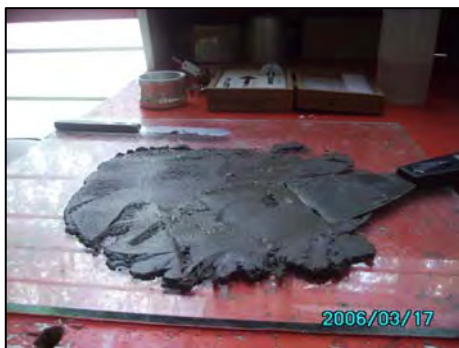
Fig. A6.4 Arena preparada para colocar en molde.
