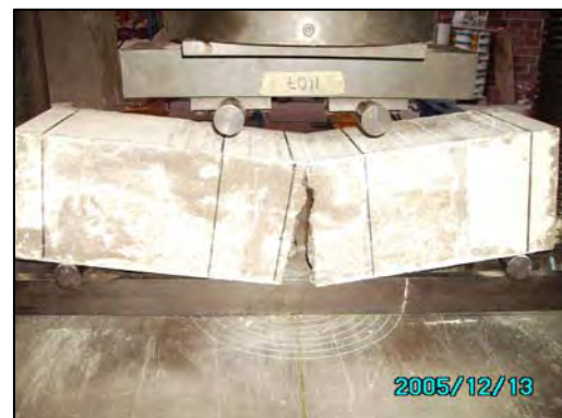
Fig. 4.6 Viga ensayada fallando en su tercio medio trazado
