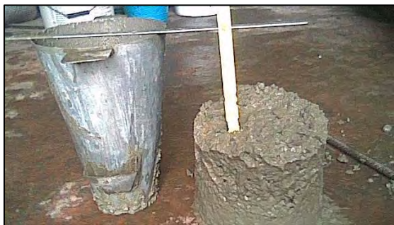
Fig. 3.8 Ensayo de asentamiento de cono de Abrams. (Arriba)
