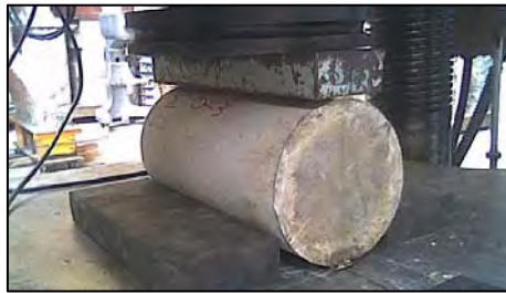
Fig. 1.19 Ensaye a Tensión por compresión diametral
