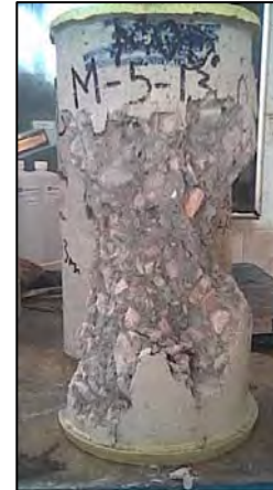
Fig. 3.12 Falla de cilindro ensayado a compresión simple.
