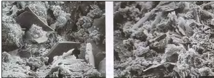
Fig. 1.16 Micrografías electrónicas de barrido de una pasta endurecida de cemento (izquierda) aumento 500X y (derecha) aumento 1000X
