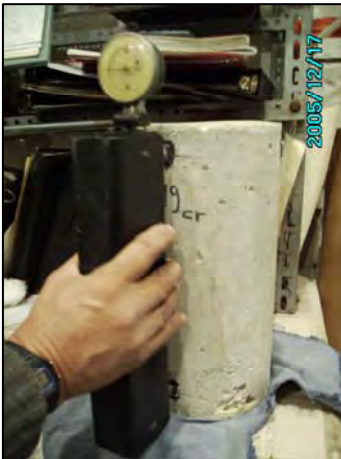
Fig. 3.26 Mediciones empleando deformimetro (equipo whitmore)
