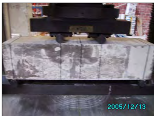
Fig. 4.5 Ensaye ASTM C-78. Viga de CBR de 15 cm X 15 cm X 60 cm.
