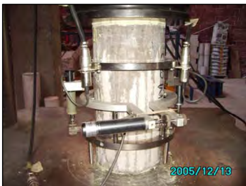
Fig. 3.18 Ensaye a módulo de elasticidad y relación de Poisson.
