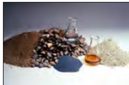
Fig. 3.2 Componentes del concreto de baja resistencia.
