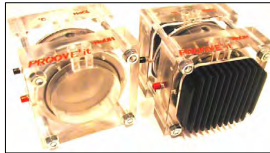
Fig. 3.33 Celdas medidoras de la permeabilidad a los iones de cloruros en el concreto.
