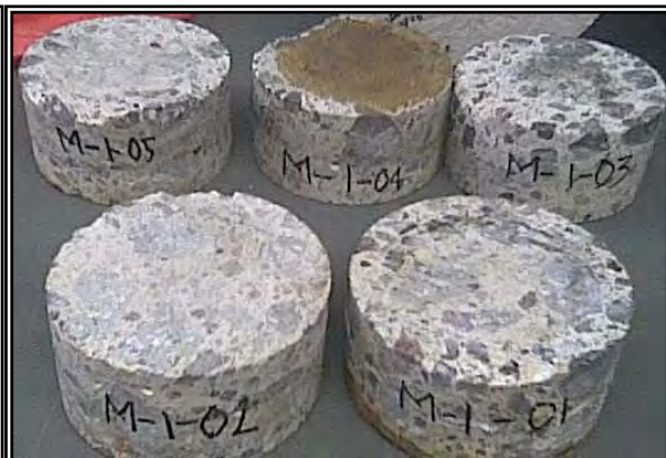
Fig. 3.35 Especimen de concreto de 100 mm de diámetro y 50 mm de espesor.
