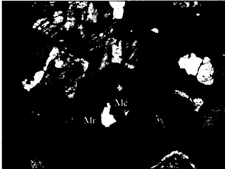
Fig. 11. Fotografía de lámina delgada de una muestra de granito del batolito de Aconchi, donde se aprecia la textura holocrystalina ligeramente porfídica y la abundancia de microclina (Mr) y muscovita (Mc). 4x.
