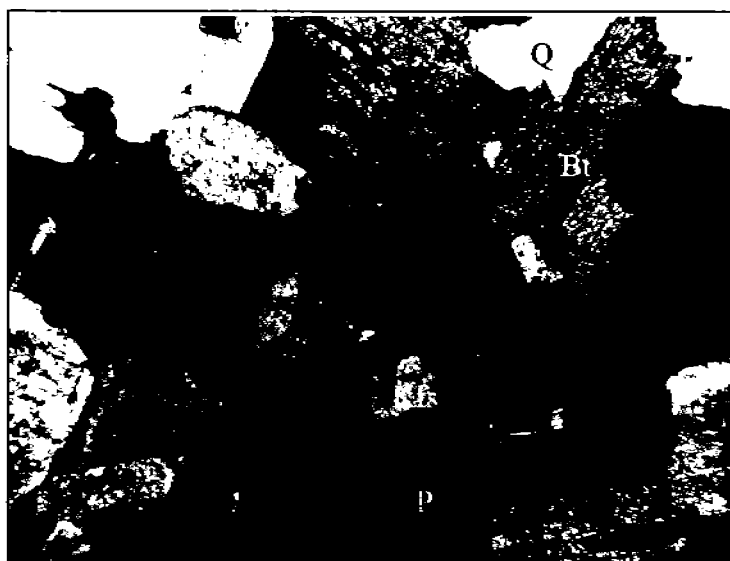
Fig. 10. Fotografía de lámina delgada de una muestra de un intrusivo granodiorítico del batolito de El Jaralito que muestra textura holocrystalina. Su mineralogía principal está representada por plagioclasa (P), feldespato potásico (Kfs), cuarzo (Q) y biotita (Bt) como mineral secundario. 4x.
