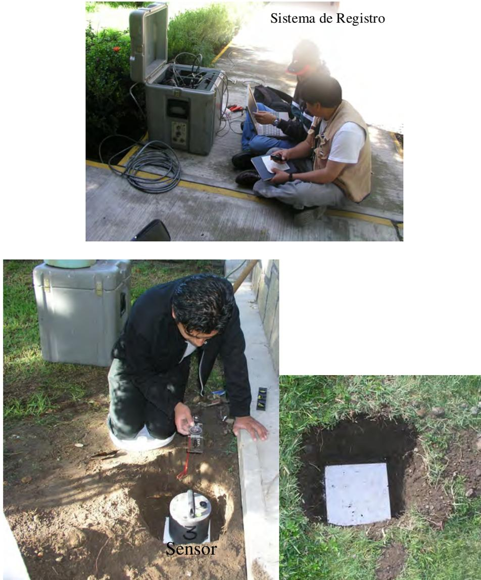
**Figura 34.** *Equipo sísmico utilizado en los arreglos sísmicos para la aplicación del método SPAC.*
