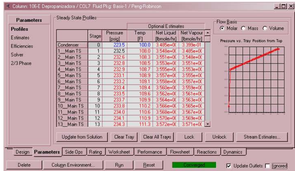
Figura 6.2 Vista de la hoja de parámetros de una columna calculada en HYSYS
