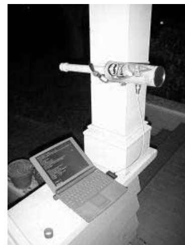
FIGURA III-2. ENVASE DE PAPAS CONVERTIDA EN ANTENA YAGI
