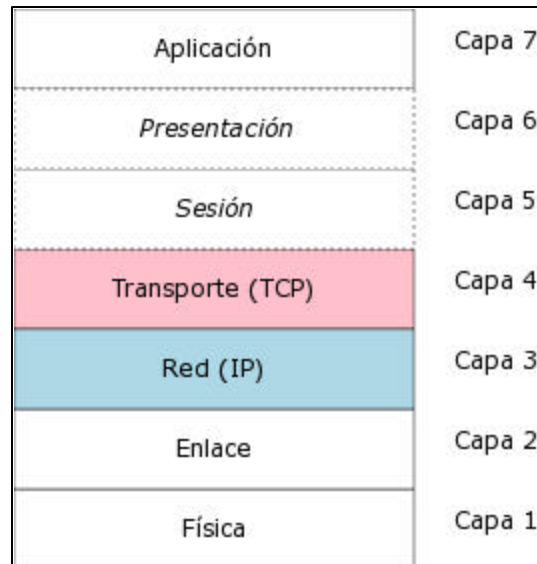
FIGURA C-1. CAPAS DEL MODELO OSI
