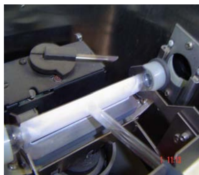
Figura III.5 Celda de cuarzo montada en un Espectrómetro de Absorción Atómica con Generador de Hidruros marca Perkin Elmer, modelo 3110.
