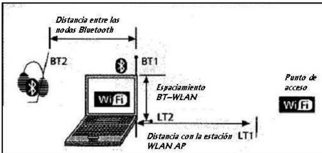
Fig. 4.4 Geometría del ambiente de medición
