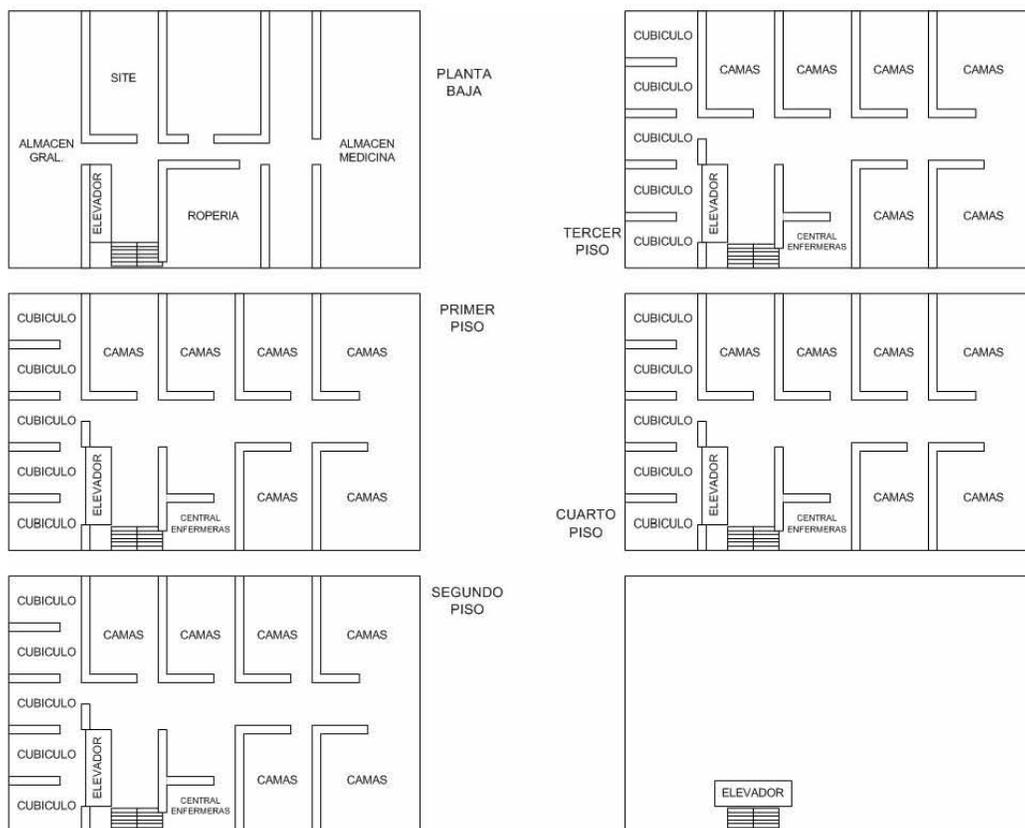
Figura 3.10. Distribución interna del edificio de Hospitalización.
