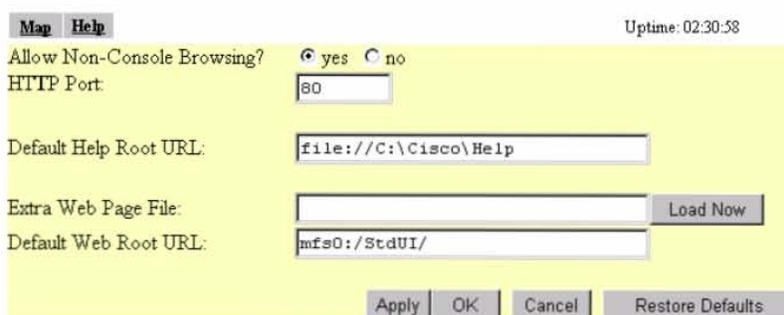
Figura 5.2. Configuración por servidor web.
