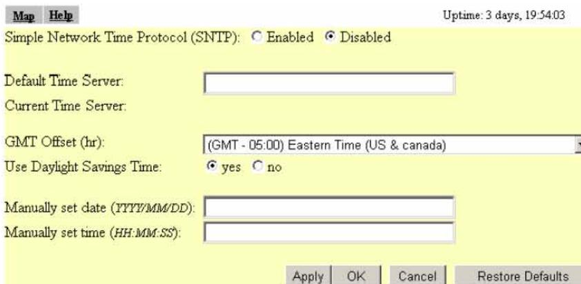
Figura 5.6. Configuración de la hora en el equipo.
