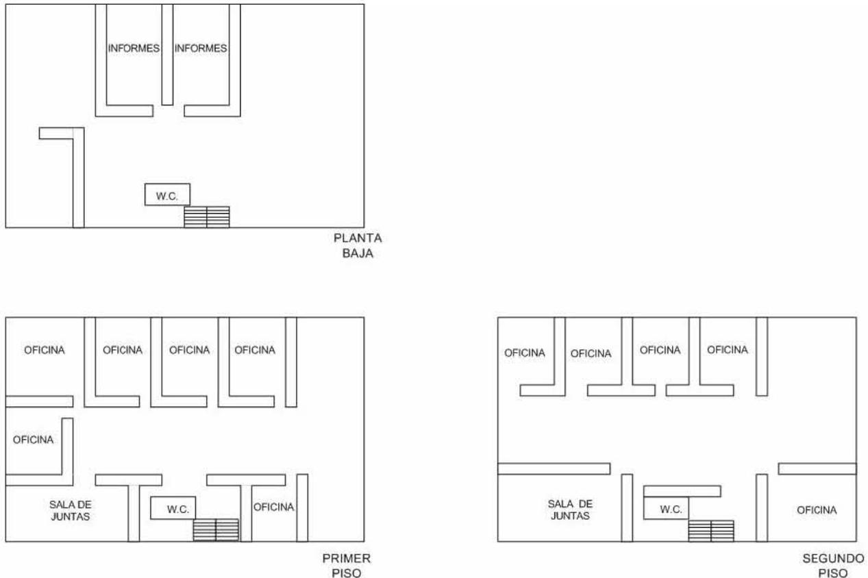
Figura 3.11. Distribución interna del edificio de Recepción.
