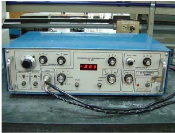
Figura 3.4. Equipo Galvanostato/Potenciostato Vimar PG-2EV.
