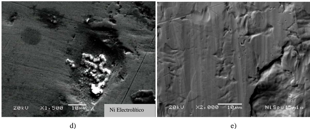
Figura 4.2. Micrografías de la superficie de: a) Acero 1018, b,d) Acero-Níquel Electrolytico, c,e) Acero-Níquel Sputtering.
