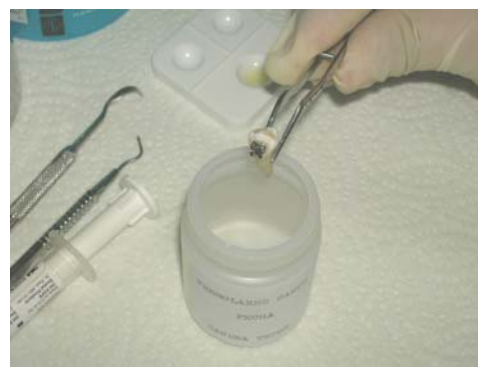
Fig. 10.25 Colocación en agua desionizada inmediatamente después de polimerizado
