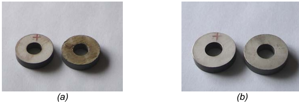
Figura. 1.4 (a) PZT con óxido, 1.4 (b) PZT una vez que se limpiaron
