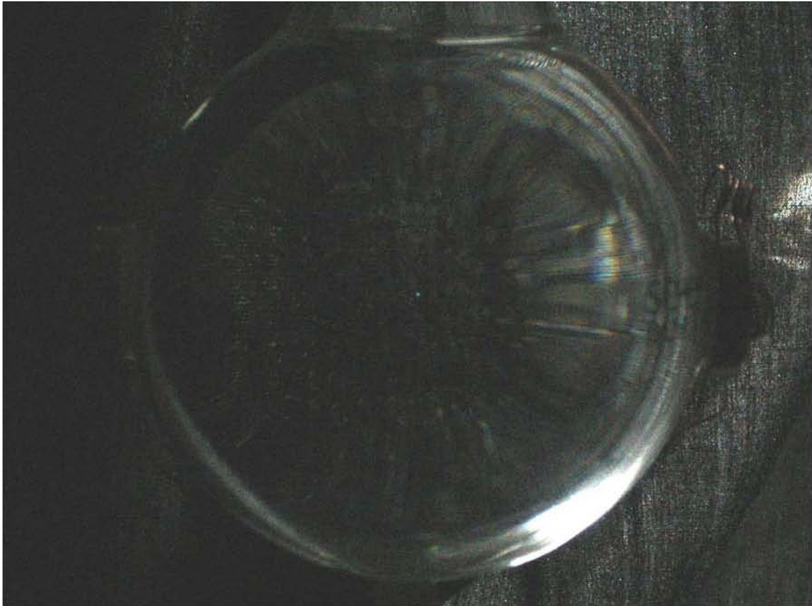
Figura 3.4.- SLSB, f=50 kHz, 20 °C, fotografía digital 7MPix, 15s exposición, ISO 400
