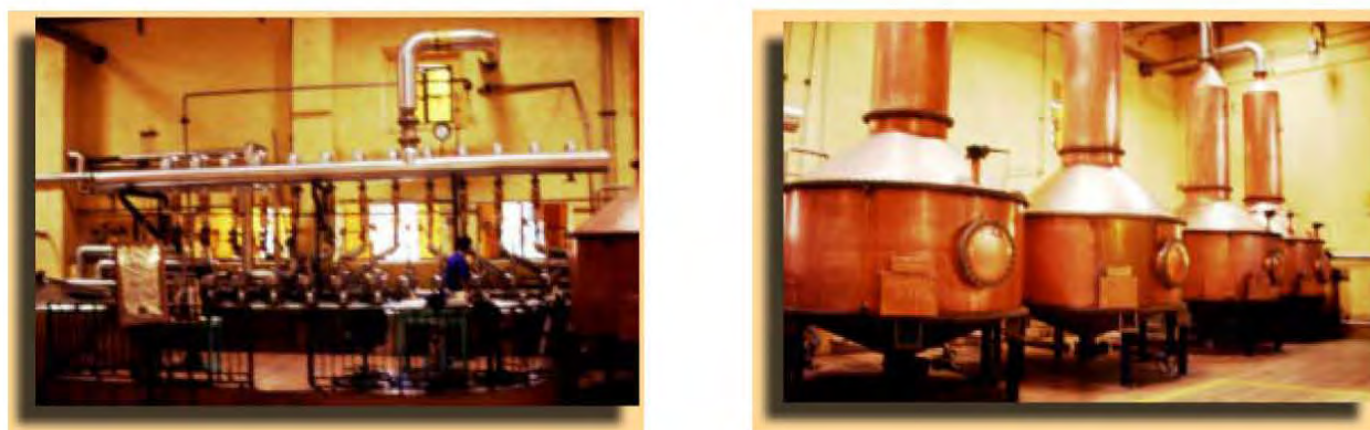
Fig. 13. Alambiques de destilación (20)
