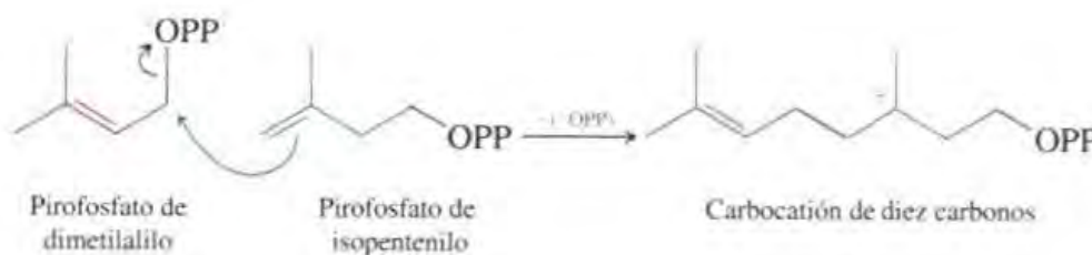
Fig. 4. Conexión de 2 unidades de isopreno
