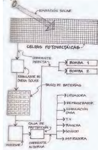
imagen 162 Generación de energía por celdas fotovoltaicas.
