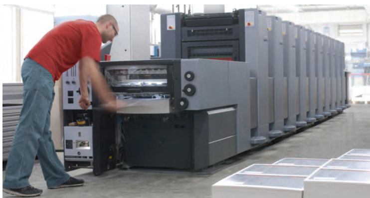
Máquina de impresión que incluye torre de barniz uv.
