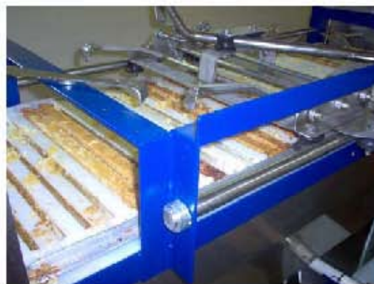
Figura 13. Tina donde caen los bastidores después de pasar por la maquina de desoperculado
