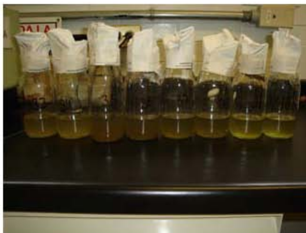
Figura 6. Frascos con caldo selenito de sodio inoculado con agua residual.
