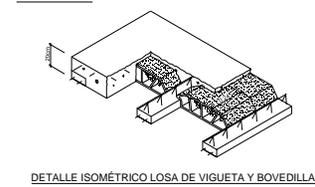
DETALLE ISOMÉTRICO LOSA DE VIGUETA Y BOVEDILLA
