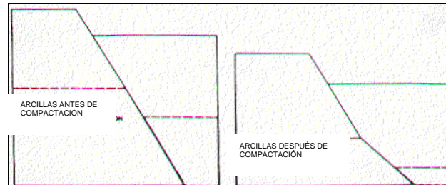
Figura 20. Aplanamiento de una falla debido a la compactación de arcillas (Shelton, 1984).
