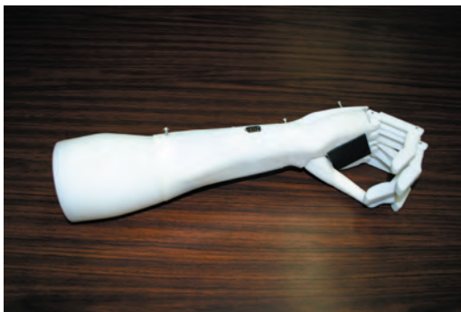
Aplicación de alambres musculares en el diseño de una prótesis de miembro superior. 2004
