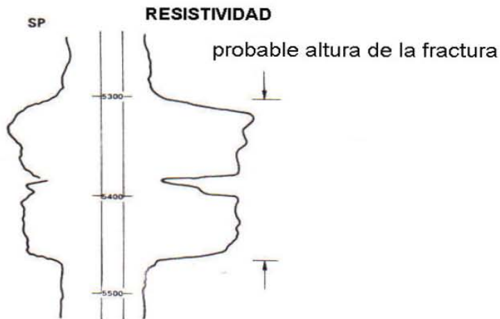
Fig 4.2 Estimación probable de la altura de la fractura para múltiples Estratos separados por delgadas barreras.
