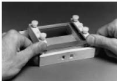
Fig. 4. Cuando este polimerizado el gel se quita de la base y se pone monta como se indica en la base que tiene los electrodos.
