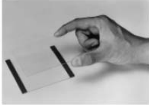
Fig. 1. Colocar los vidrios como se muestra en la figura colocando los espaciadores entre ellos.
