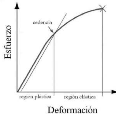
Figura 2.2 Curva típica de esfuerzo-deformación donde las regiones tanto elástica como plástica son divididas por el punto de cedencia (nivel de esfuerzo en el cual se origina el daño permanente en la matriz ósea). 9
