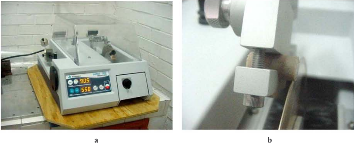
Figura 4.5 El paralelismo entre las caras laterales de las muestras cilíndricas son más aproximadas cuando se emplea una máquina con disco cortador de diamante donde nuevamente se emplea agua como lubricante.
