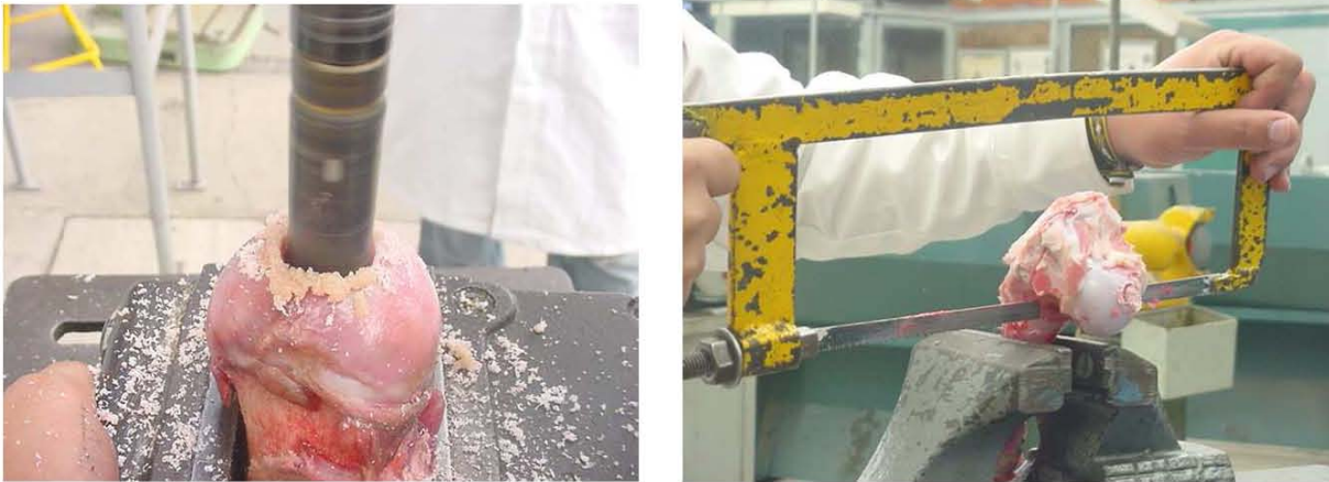
Figura 4.4 Durante cualquier proceso de corte se debe mantener una sujeción adecuada de la porción a partir de la cual se van a extraer las muestras, así mismo se aplica agua abundante como lubricante para evitar el calentamiento de las mismas.
