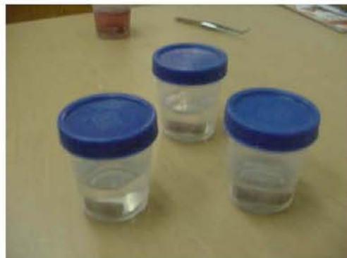
Figura 4.8 Si las probetas maquinadas no son ensayadas inmediatamente, se conservan en solución salina y dentro de envases herméticos para evitar en la medida de lo posible la degradación, inclusive se pueden mantener refrigeradas antes de iniciar cualquier prueba.
