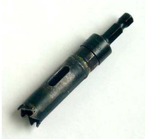
Figura 4.3 La herramienta de corte se encuentra disponible a diferentes diámetros y longitudes; ésta permite obtener muestras cilíndricas del hueso y se emplea principalmente para hueso esponjoso
