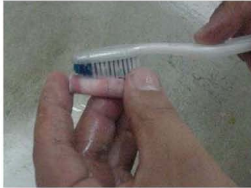
Figura 4.7 La limpieza de las muestras ayuda a remover las sustancias indeseables (médula ósea o partículas de tejidos blandos, grasa debido a la herramienta) teniendo precaución de no provocar ningún daño.
