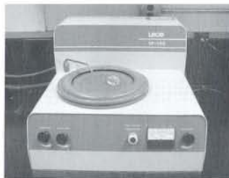
Figura 4.6 A través de un desbaste de las superficies planas, se pueden eliminar irregularidades en las muestras. Si se emplea una pulidora como la mostrada en la figura, la velocidad recomendada es de 400 rpm.
