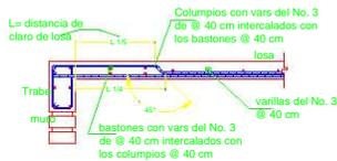
Columnas con vars del No. 3 de @ 40 cm intercalados con los bastones @ 40 cm
