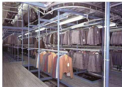
Ilustración 29 sistema de almacenaje por medio de rieles y cadenas para distribuir las prendas según embarques, con dos niveles para colgar.
