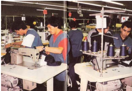
Ilustración 25 sistema modular de costura, en donde el operario, cambia de estación de trabajo, para realizar las diferentes operaciones de una prenda.
