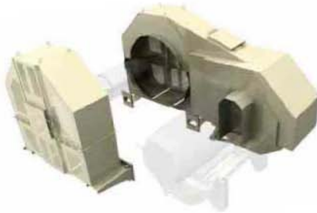
Fig. II.12 Protectores de los volantes de inercia, alrededor de la trituradora.
