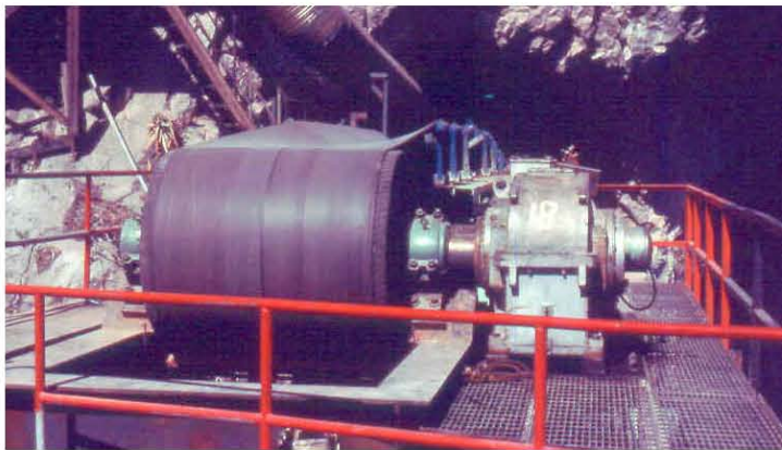
Fig. III 34. Propulsión de una banda caguama
