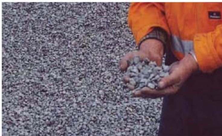
Aspecto del agregado al pasar por la trituradora de impacto
