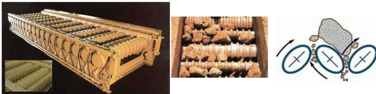
Fig. III.17 Funcionamiento del alimentador oscilante.
