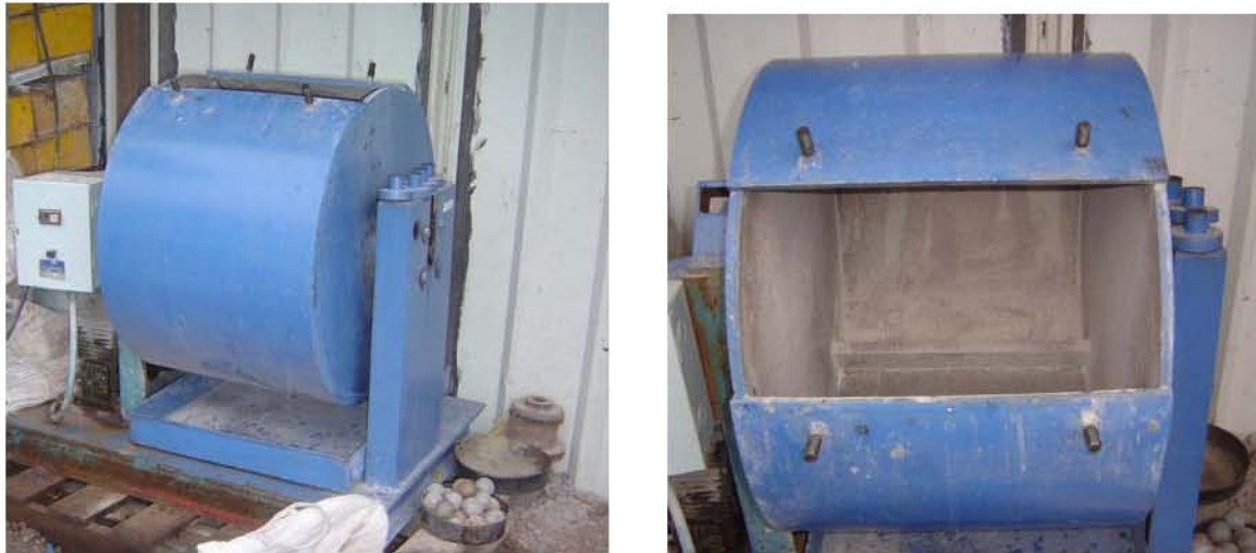
Fig. 1.5 Esquemas y fotos del equipo que sirve para realizar la prueba de Los Ángeles, en el extremo inferior derecho se ven las bolas de acero que se mezclan con la muestra.
