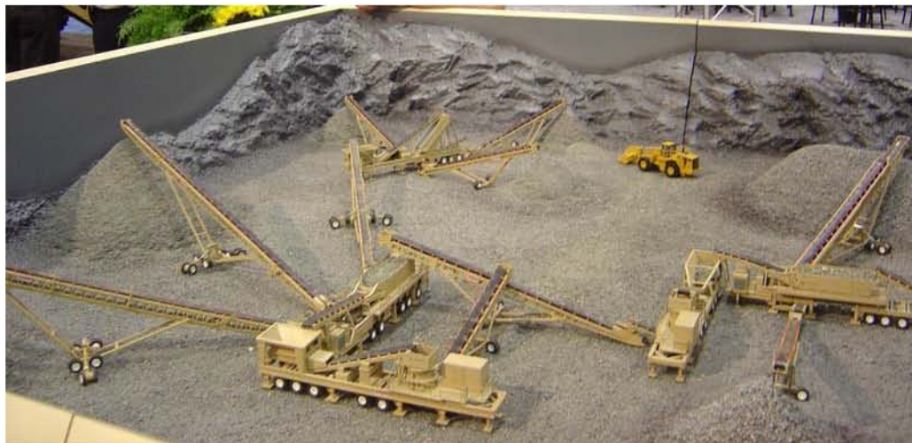
Fig. IV.18 Maqueta de planta de trituración de agregados.
