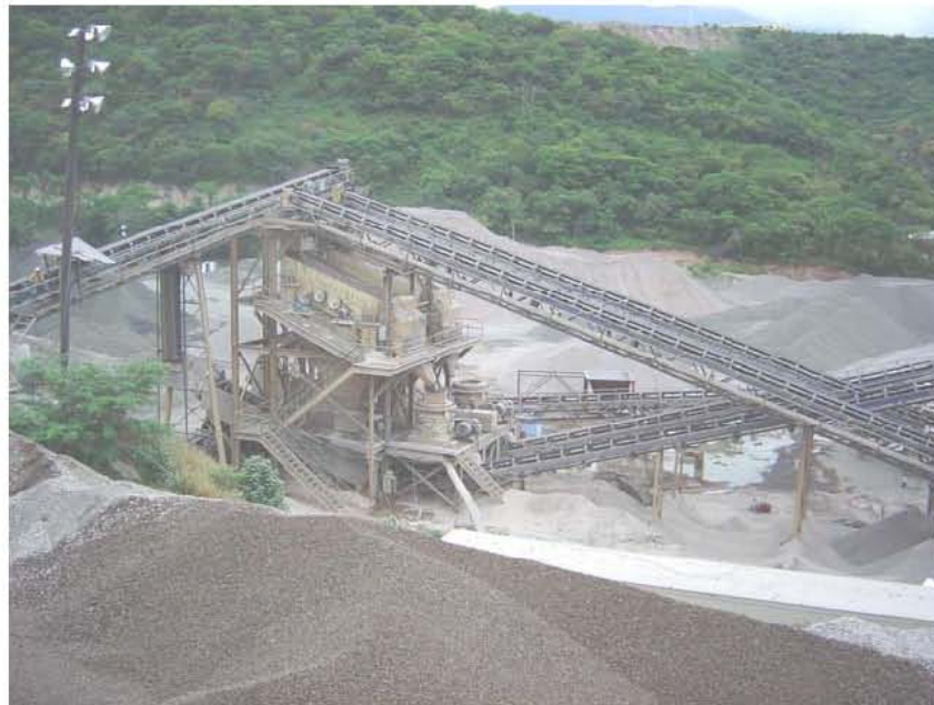
Fig. IV. 13 Criba que alimenta a dos trituradoras terciarias, se aprecia el material que entra a la criba que está en circuito cerrado.
