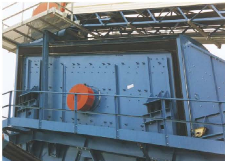
Fig. III.38 Criba sellada para protección contra el polvo.
