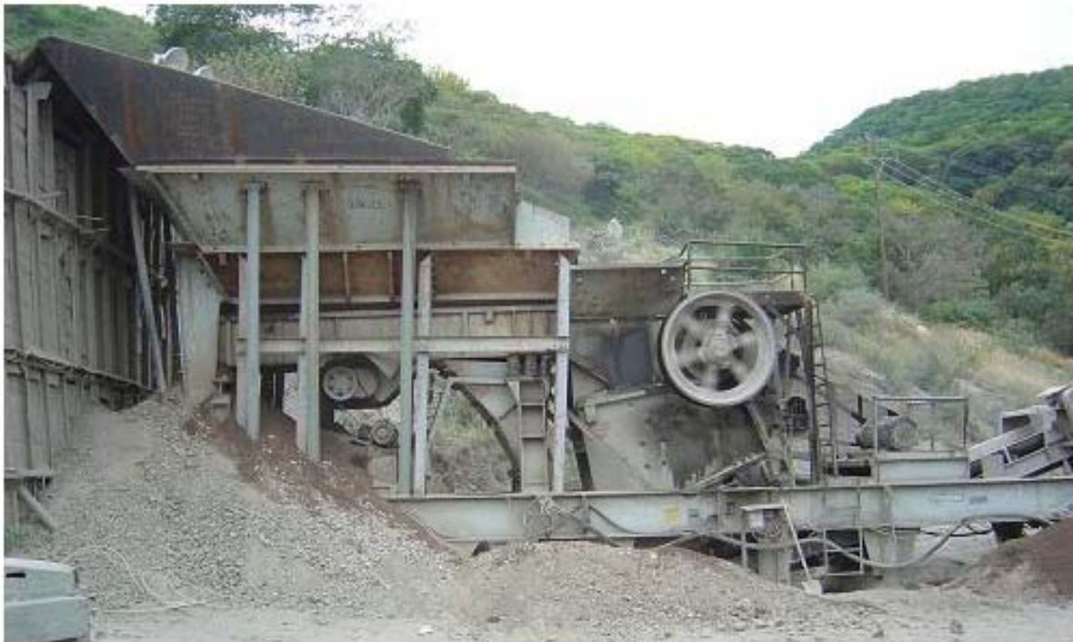
Fig. III.3 Vista en conjunto de la trituración primaria de una planta de trituración portátil, (“El Cajón”, Nayarit) donde se aprecia de izquierda a derecha, la tolva de recepción de la fig. III.2 b); debajo de la tolva está un alimentador grizzly y hacia la derecha una trituradora de quijadas.
