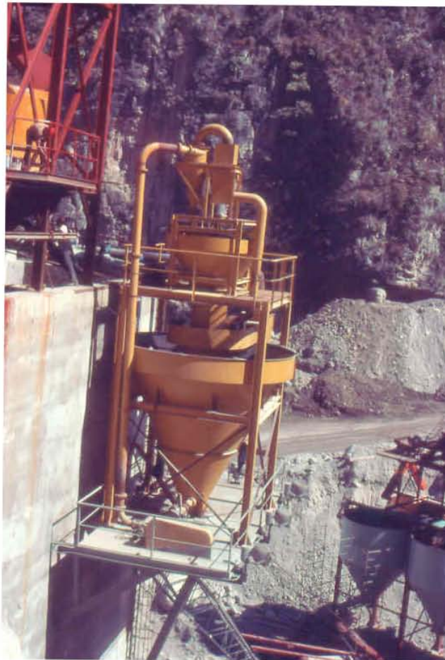
Fig. III.49 Diagrama de planta que incluye tanque lavador y ciclón
