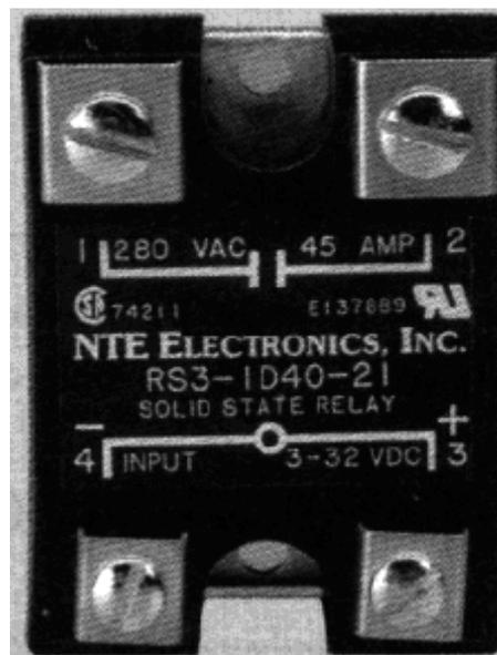
Figura 3.19 Interruptor de estado sólido 280 Volts a 40 Amperes (Entrada de 3 a 32 Volts de C.D.)
