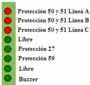
Los LEDS libres son de uso general y pueden ser programados según las necesidades. El LED “buzzer” se conecta mediante un transistor a un generador de tono que indica si se ha activado alguna protección.
