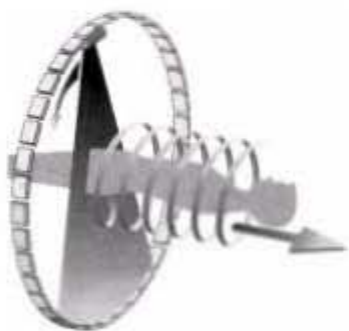
Figura 1.4 Principio de funcionamiento de un tomógrafo computarizado [W1]. 6ª Generación
