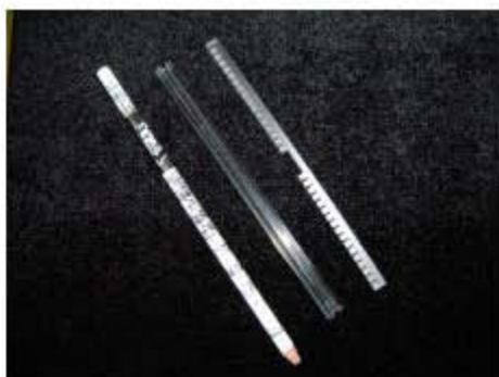
Figura 4.5.b Aditamento para colocar dosímetros termoluminiscentes
