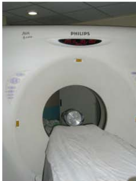
b) Colocación del maniquí dosimétrico.
