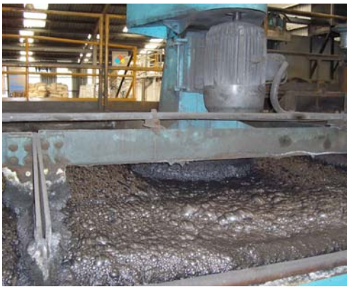
Foto 13: Celda de flotación
